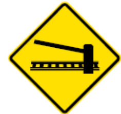
CRUCE FERROVIARIO A NIVEL CON BARRERAS PI - 1b
